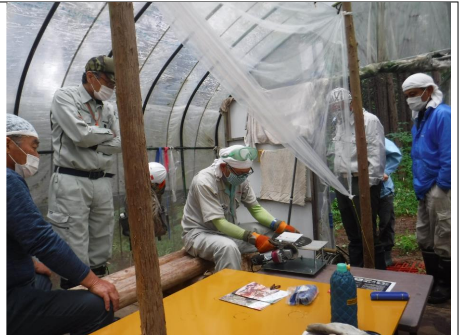
修正定規で正しい刃の形をけがいて、さあ研ぎだします
