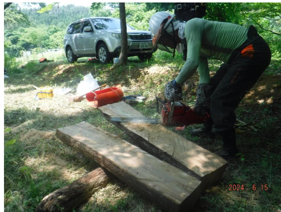
チェーンソーで二つ割りにして座面を仕上げます
